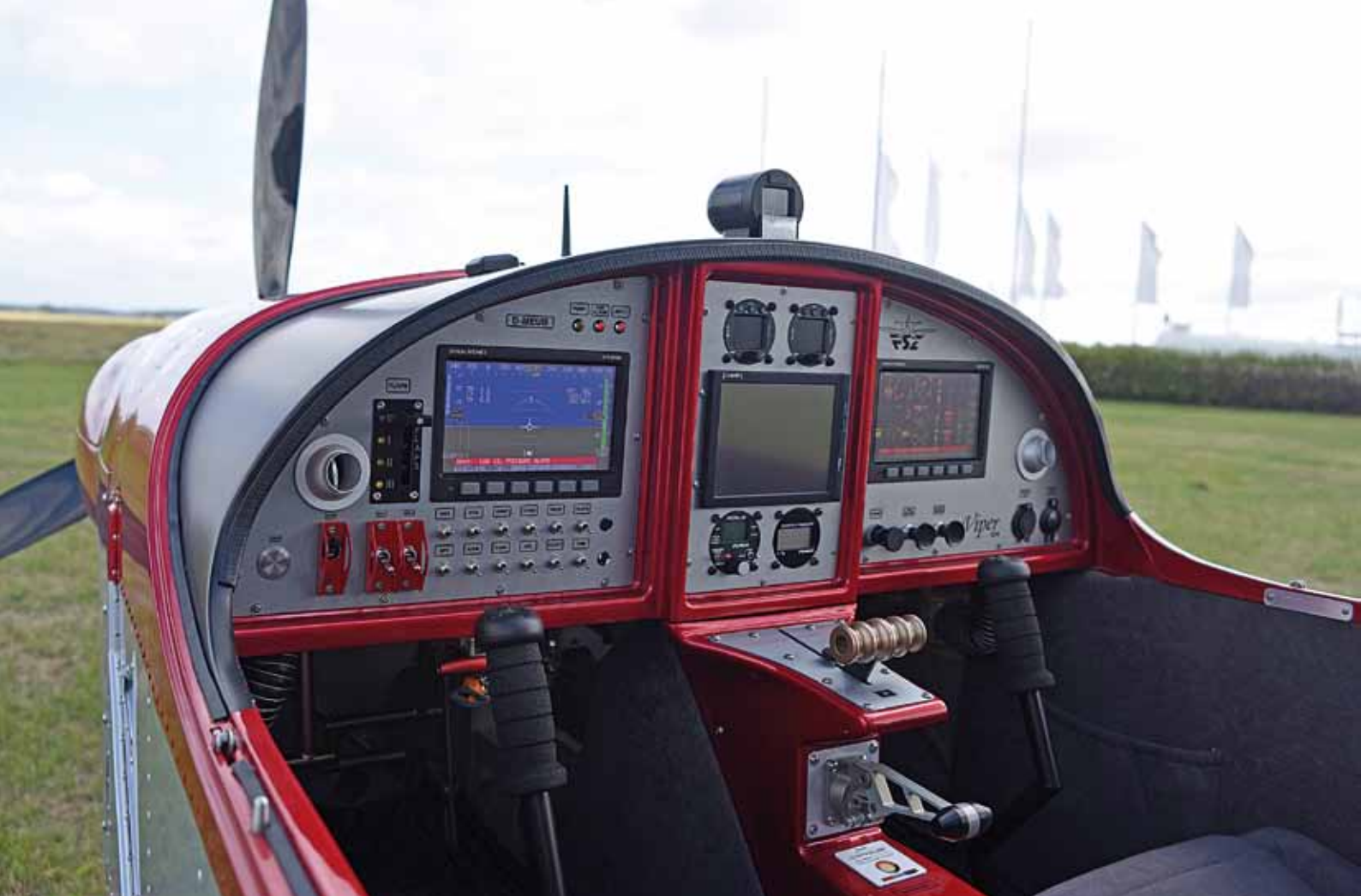
Le Viper est un ULM haut de gamme parfaitement abouti, idéal pour le voyage mais également l'écolage. Sa planche de bord en trois parties comporte, ici, toute l'aviation utile à la navigation, les paramètres moteur et vol.
